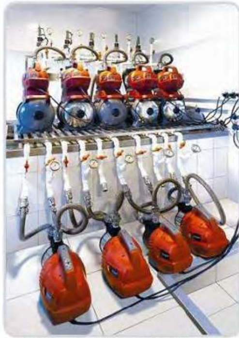
▲ Garterpumpen / Hauswasserwerke - Dauerlauf Prüfung
